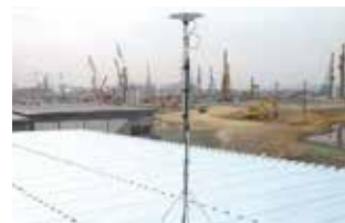
GNSSアンテナ 基準局座標はアンテナ位相中心での値を公表している
